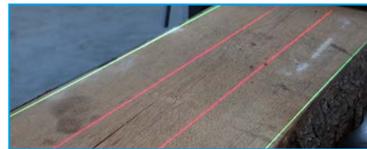
Abb. 3: Linienlaser zur gezielten Ausrichtung der Werkstücke
