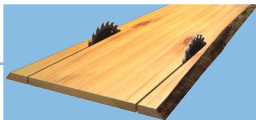
Fig. 23 : Sciage sur la déligneuse à deux lames
