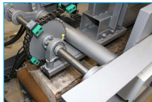
Fig. 8 : Les rouleaux inférieurs et la chaîne entraînée par le haut garantissent le transport précis dans la déligneuse.
