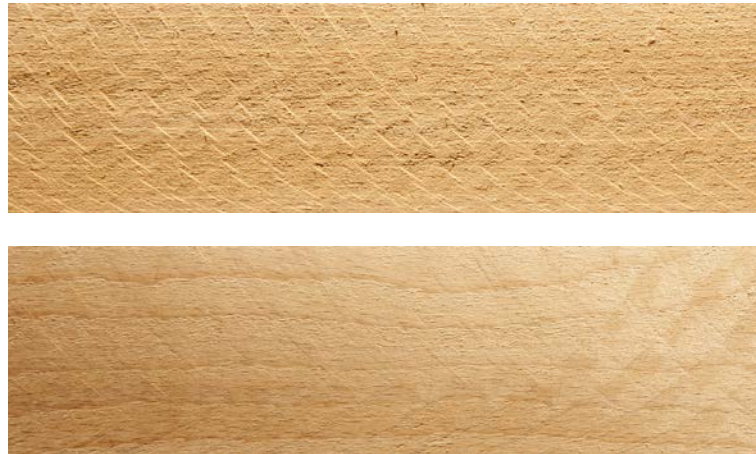
Fig. 4: La comparaison directe indique la haute qualité de la coupe apte au collage réalisée sur une machine du modèle Q (en bas).
