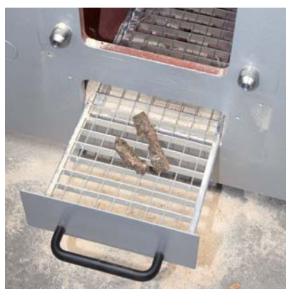
Abb. 2: Ein Gitterrost (Option) verhindert, dass große Spreißelstücke und Rindenteile in die Absaugung gelangen
