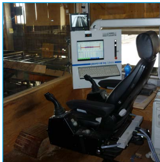
Abb. 2: Kontrollzentrum in der separaten Kabine
