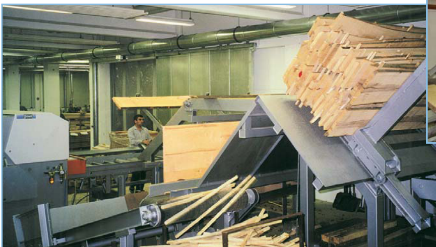
Fig. 4 Dépilage automatique, transport des liteaux d'empilage et dispositif de renversement
