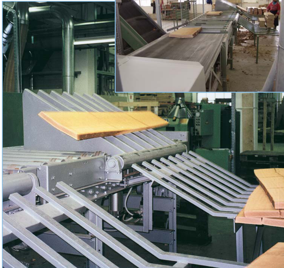
Fig. 11 Ejection automatique de longueurs fixes dans la station de tri souhaitée.
