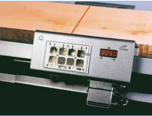
Fig. 9 Chariot de mesure avec des touches de fonction robustes et un écran lumineux
