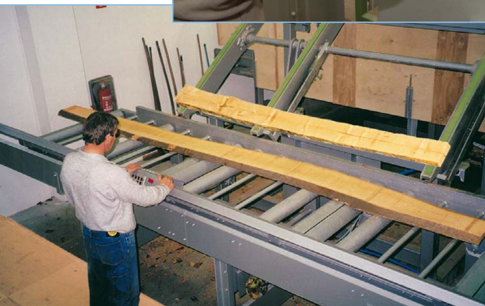
Fig. 8 Marquage sans contact à l'aide d'un laser et de touches de fonction
