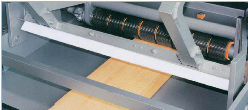
Fig. 3 Intérieur d'une tronçonneuse 18GE: rouleaux supérieurs segmentés, balai orientable
