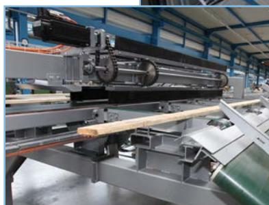
Fig. 17 Séparateur pour l'alimentation de deux tronçonneuses
