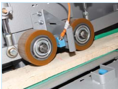
Abb. 9 Separate Messstation erkennt die Positionen der Kreidemarkierungen
