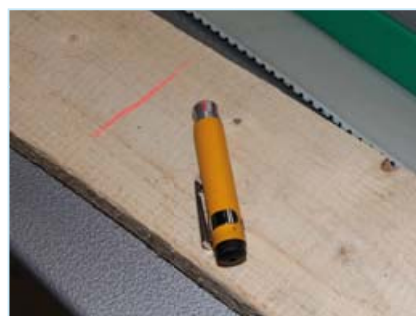
Abb. 11 Kreide zum Markieren von Fehlerstellen
