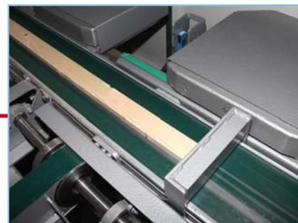
Fig. 3 Butée asservie par servo-moteur
