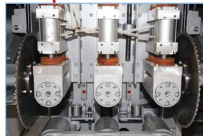
Fig. 2 Lames de scie avec servo-moteur
