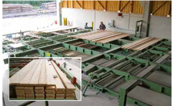
Auf zwei Ebenen erfolgt die Zuführung zur Stapelanlage: Mitarbeiter Gerhard Waltinger kontrolliert die Ware (Paketbildung siehe kleines Foto)
