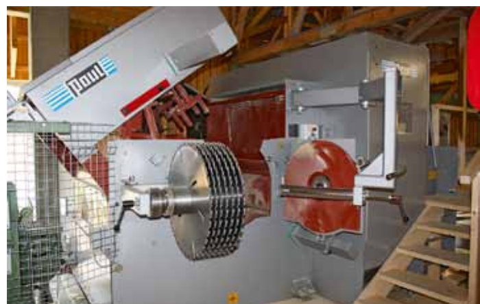
Zum schnellen Umrüsten ist an der Außenseite der Paul-Nachschnittkreissäge ein fertiger Einhang einsatzbereit
