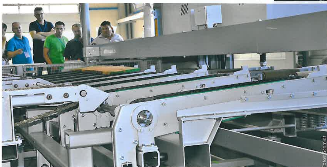
Das Highlight der „Expo“ von Paul und Reinhardt war eine Laubholz-Zuschnittanlage. Direkt nach der Bandsäge gelangen die Eichenbretter über eine automatische Beschickung in die Besäumkreissäge
