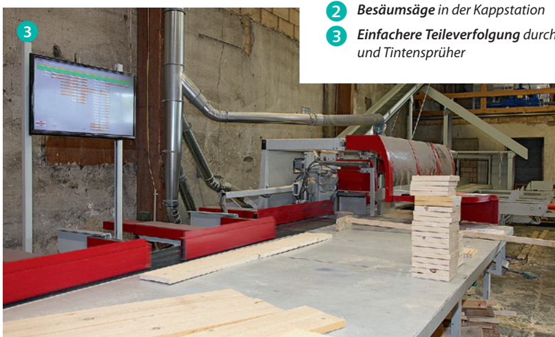
1 SlimLine F mit eingangsseitigem Pufferkettenförderer, aufsteigendem Abfallförderband, Sortiermonitor und -tisch
