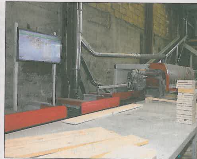
Einfachere Teilverfolgung durch Monitor (links) und Tintensprüher
