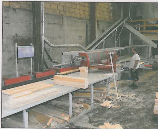
„Slim-Line F“ mit eingangsseitigem Pufferkettenförderer, aufsteigendem Abfallförderband, Sortiermonitor und Sortiertisch
