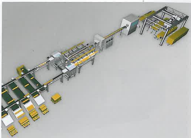
PAUL-Doppelkapplinie mit Vakuumentapelung, Hobelmaschine, Paul-»Wood Scanning«-System, zwei »C11«-Kappanlagen und Sortiersystem.
