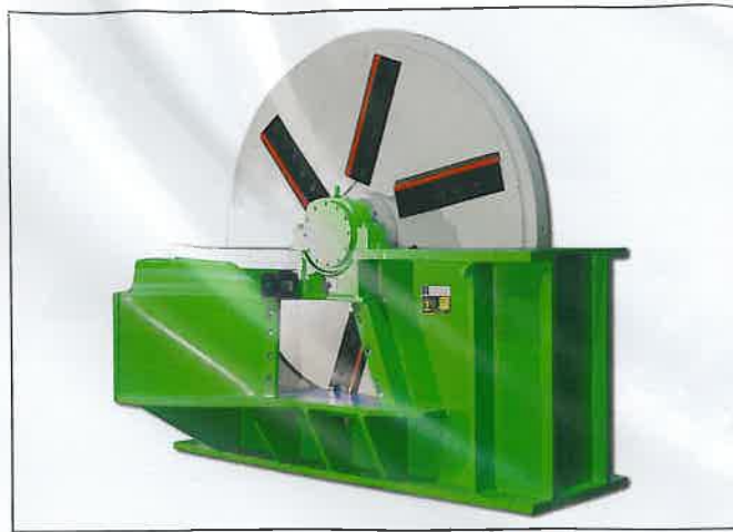
Speziell für die MDF-Herstellung von PALLMANN konzipiert: der leistungsstarke Scheibenhacker vom Typ »PHS 30H12«.
