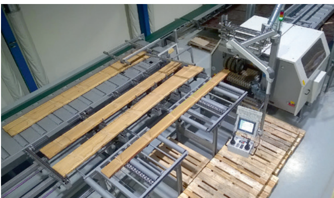
Laserlinien zeigen die Positionen der Sägeblätter, Kettenbetten garantieren die exakte Führung der bis zu 7 m langen Werkstücke durch die Maschine
