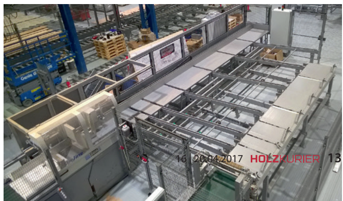
CNC-Kappanlage des Typs SlimLine mit automatischem Schiebervorschub für besonders exakte Kappergebnisse
