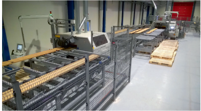
Zwei Paul-Auftrennkreissägen des Typs K34V/1000 übernehmen das Besäumen der Harthölzer
