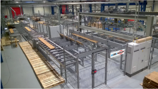
Massivholzdielen-Fertigung: Blick über die Vakuumentstapelung, Wende-einrichtung und Untertischkappsäge
