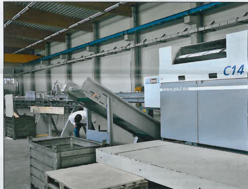
W urządzeniu do obrzynania „C14_MKL” wycinane są „wady drewna” z obrzanych desek.
