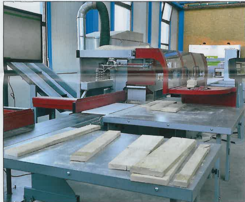
„Slimline” nazwano multitalentem wśród pil poprzecznych, ponieważ pracuje on w pełni automatycznie i dysponuje również obrzynarką pilową.
