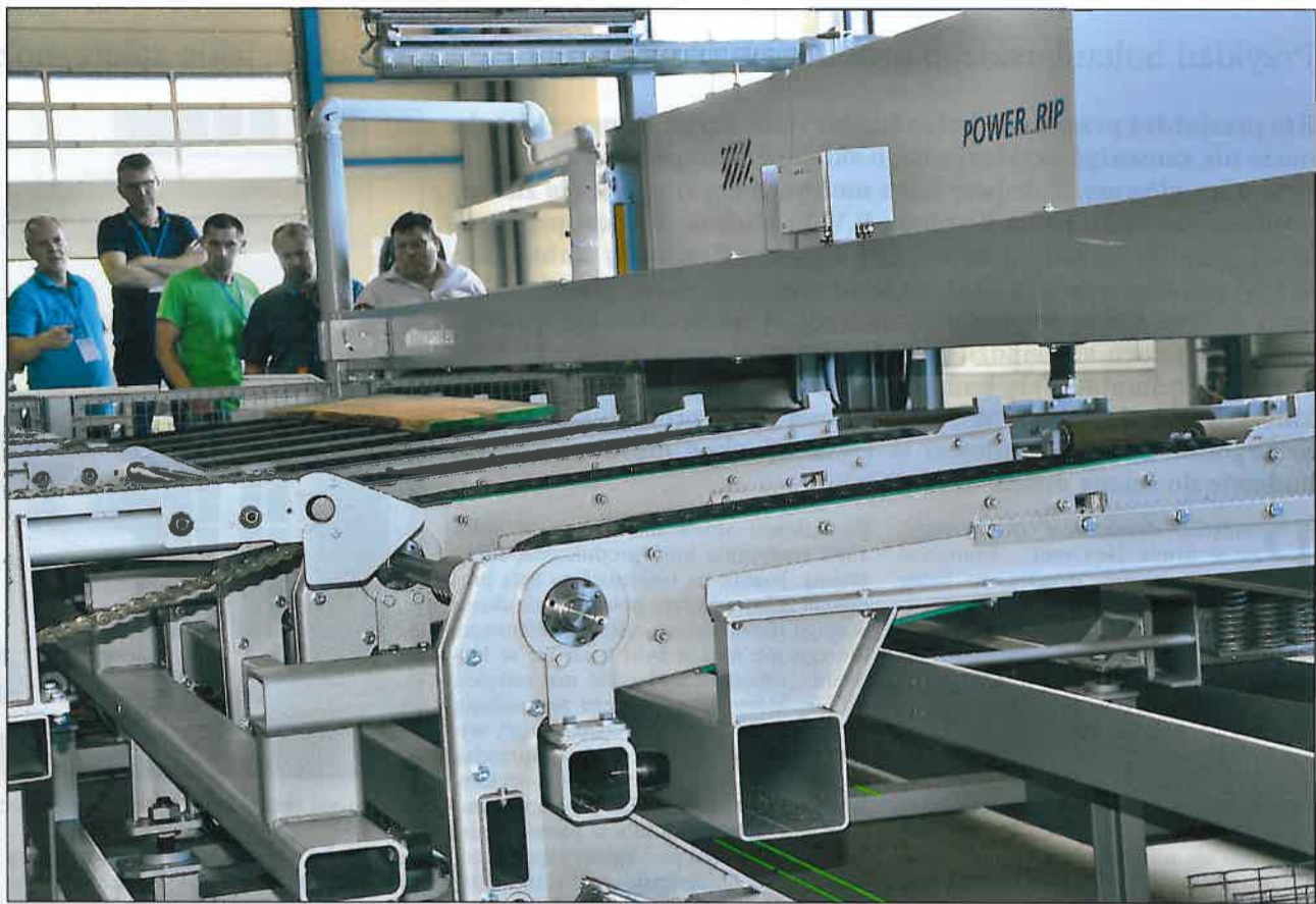
Główną atrakcją targów „Expo”, zorganizowanych przez firmy Paul i Reinhardt była kompletna linia produkcyjna do półfabrykatów wymiarowych z tarcicy liściastej. Bezpośrednio za pilą taśmową deski dębowe trafiają poprzez automatyczne napelnianie w pilarkę tarczową wzdłużną.
