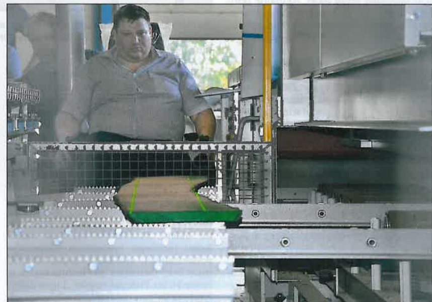
Przebieg cięcia brzeszczotów piły znakują linie lasera.
