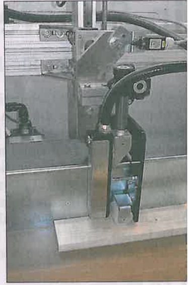
Kappen und bedrucken: Salvador zeigte eine „Superpush 250“ mit integrierter Druckeinheit (rechts), die berührungsfrei Markierungen, Barcodes oder Schriftzüge (kleines Bild) bei normaler Produktionsgeschwindigkeit aufs Holz druckt.
