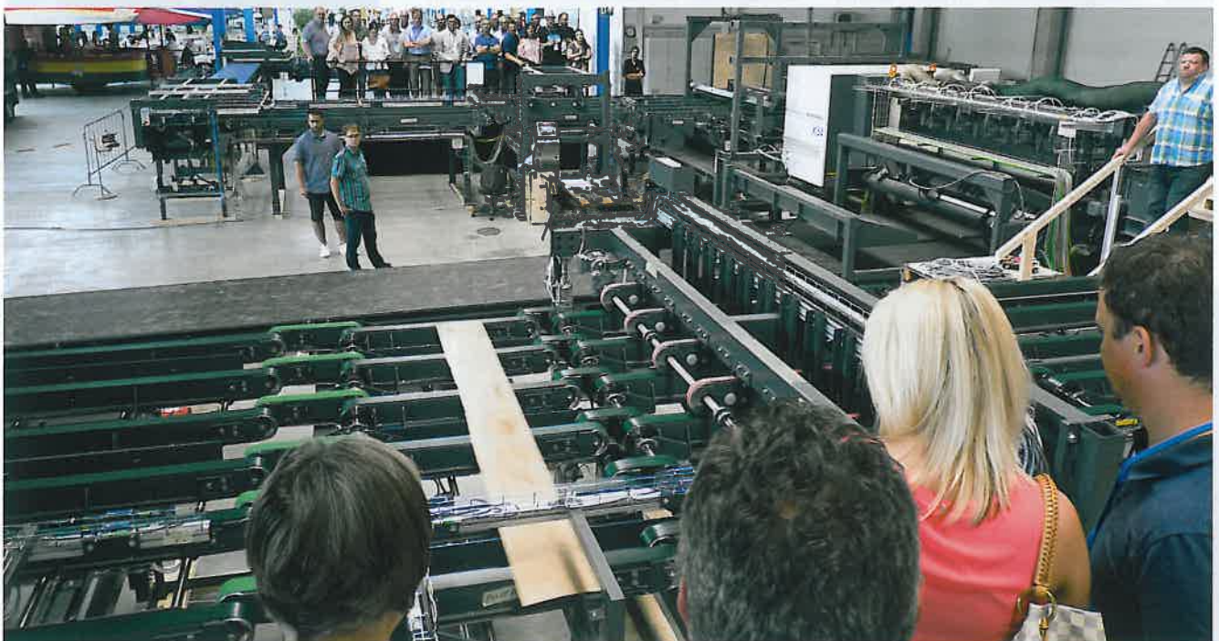
Der „Star“ der Paul-Hausmesse: eine komplexe Zuschnittanlage zur Herstellung von Starkfurnieren
