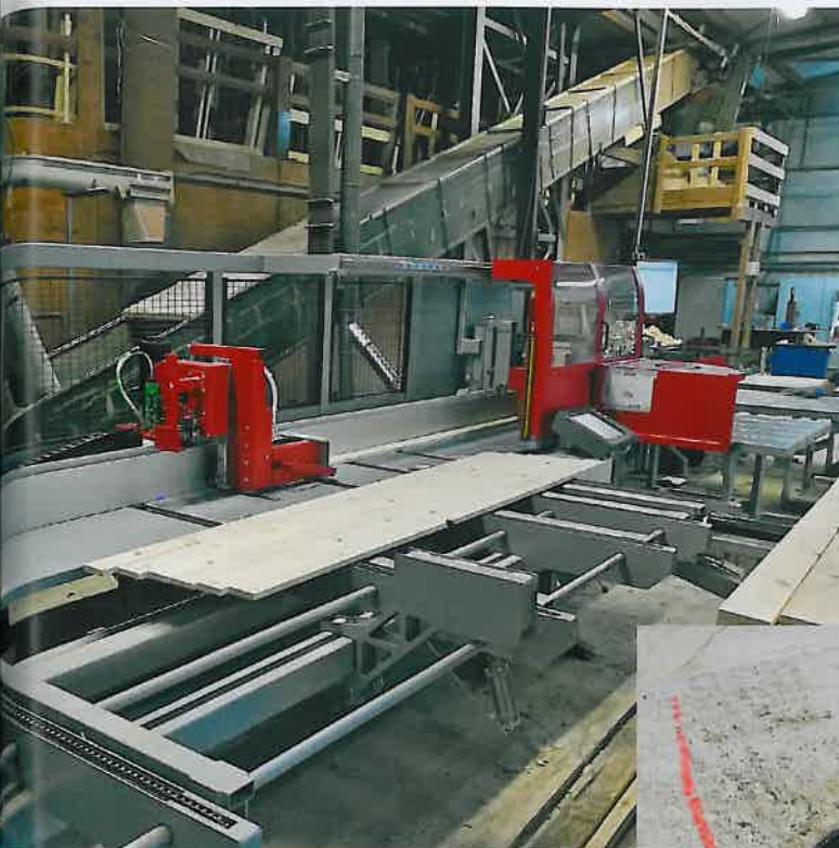
Der Positionierschieber erfasst beim Rückhub die Länge sowie die markierten Fehlerstellen und schiebt das Werkstück durch die Kappstation
