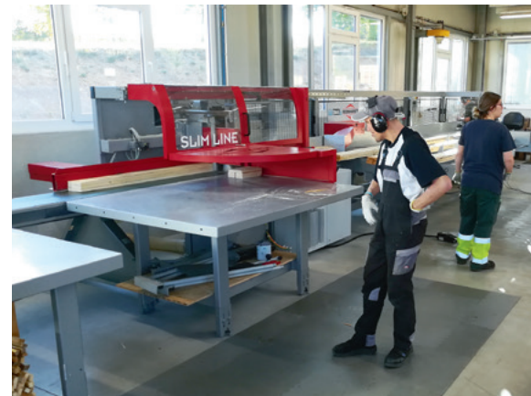
Nach dem Kappen werden die Hölzer auf einen Tisch abgeschoben und gestapelt
