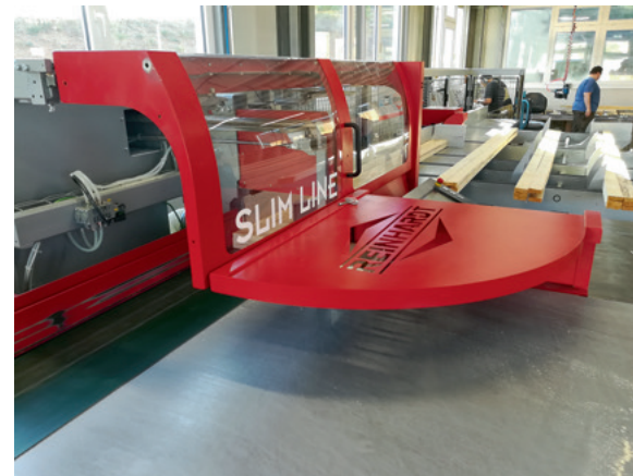
Bei Westeifel Werke ist eine Kappanlage des Typs SlimLine 170 im Einsatz
