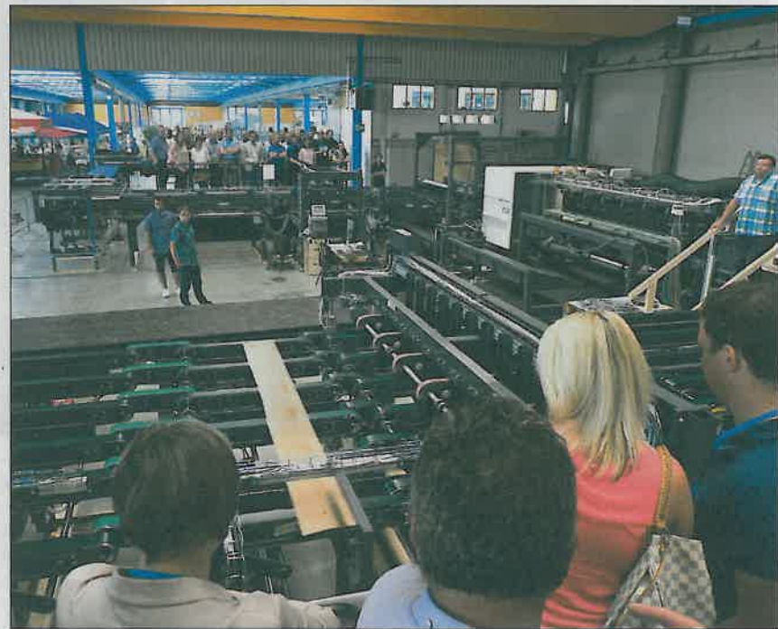
Der „Star“ der Paul-Hausmesse: eine komplexe Zuschnittanlage zur Herstellung von Starkfurnieren. Fotos: Bolz
