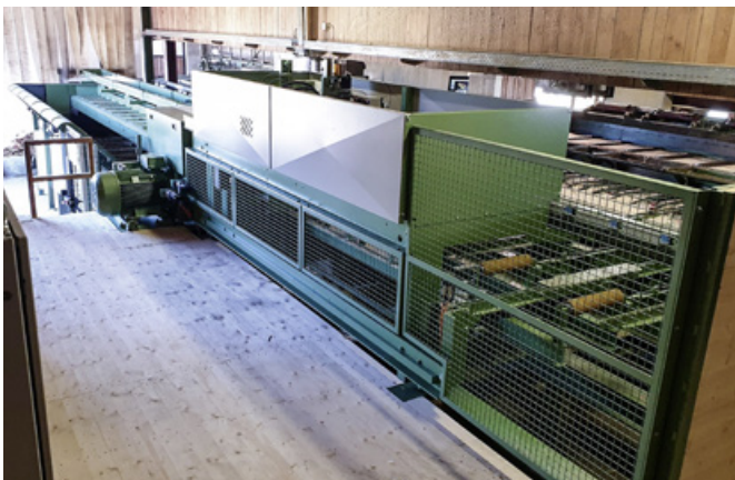
Das automatische Beschickungssystem AB920 dreht die Werkstücke in die optimale Position und führt sie dann der Besäumkreissäge zu
