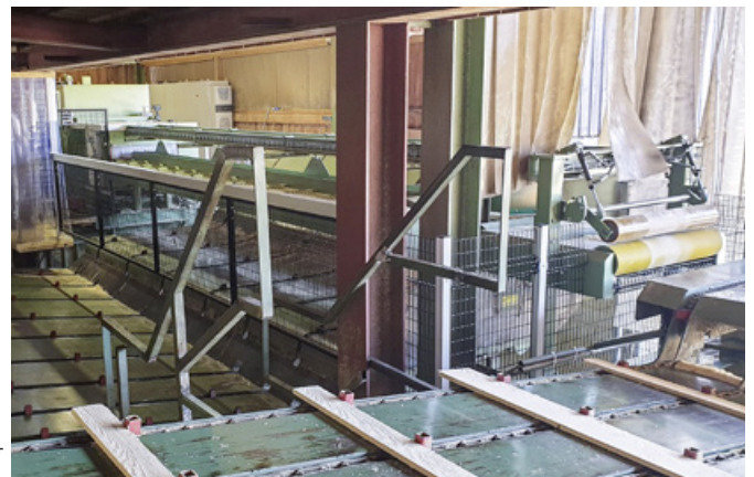
Der automatische Spreißelabscheider trennt zuverlässig die Waldkante von den Werkstücken
