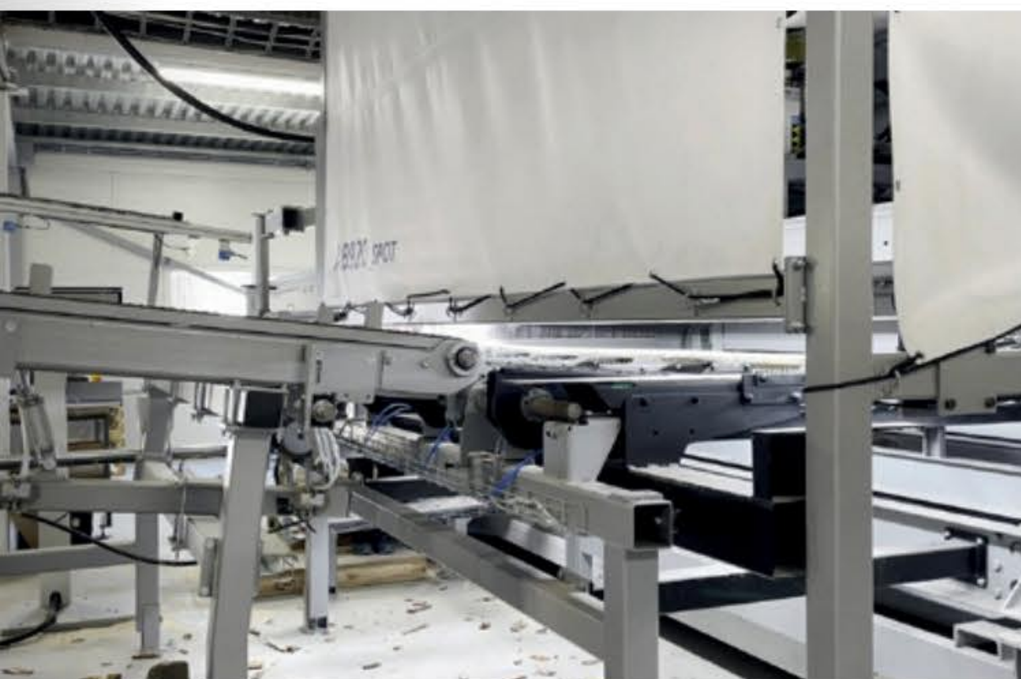
Das automatische Beschickungssystem AB920_Spot erkennt die Lage der Werkstücke und positioniert diese nach der Vorgabe des Scanners vor der Auftrennkreissäge
