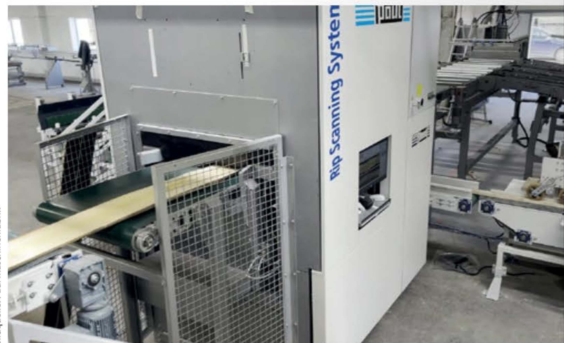
Das Paul Rip-Scanning-System erfasst die Werkstücke im Durchlauf von oben und unten und berechnet die Optimierungsergebnisse zum Auftrennen und Kappen
