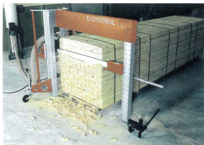
Die Paketkappsäge ist mobil und einfach zu bewegen (Bild: Logosol).
