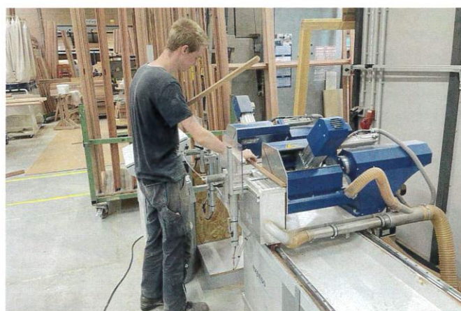
Einfache Bedienbarkeit und hohe Präzision sind die zentralen Merkmale der Doppelgehrungssäge (Bild: Hecht).
