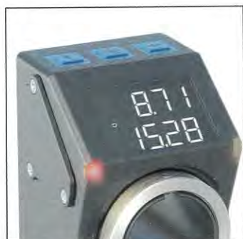
Einfach abzulesende Soll- und Ist-Werte sowie Drehrichtungspfeile und Status-LED erleichtern die Formatverstellung (Bild: Siko).
