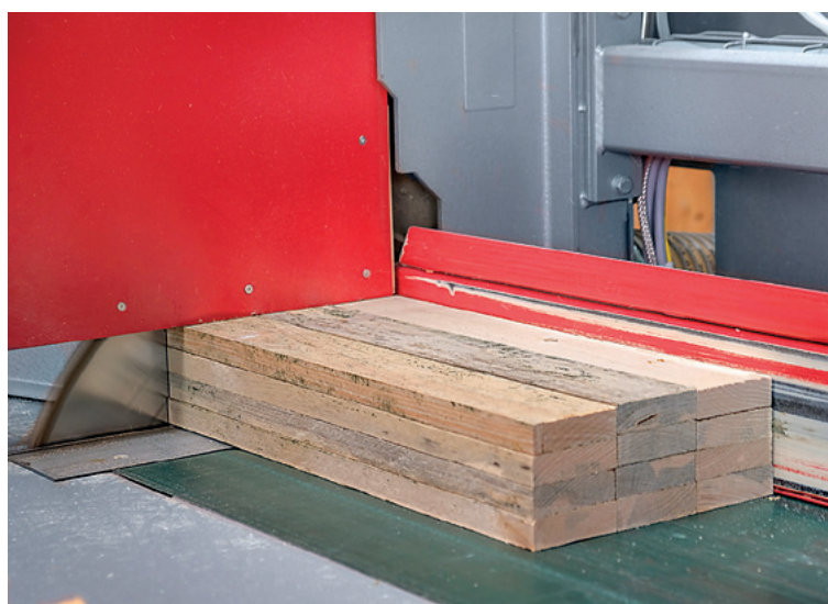
Exakter Schnitt: Der massiv ausgeführte Abdrücker garantiert einen rechtwinkligen Zuschnitt
