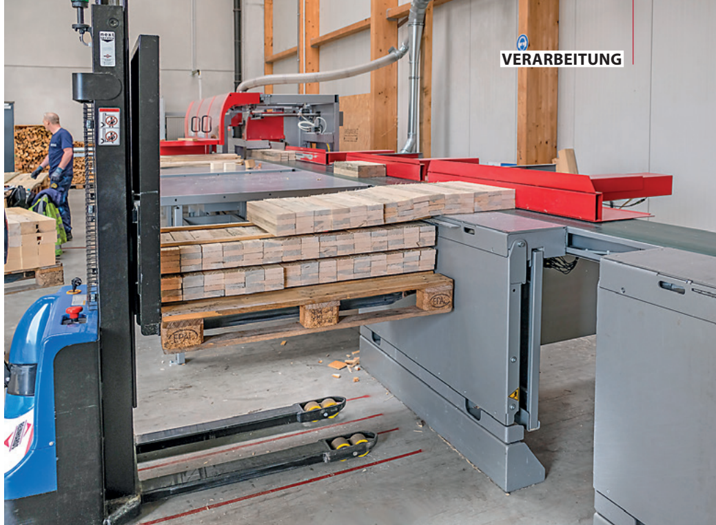
Automatische Stapelung: Der Bediener muss lediglich die Stapellatten legen. Der Rest erledigen die Abschieber und die halbautomatischen Stapler
