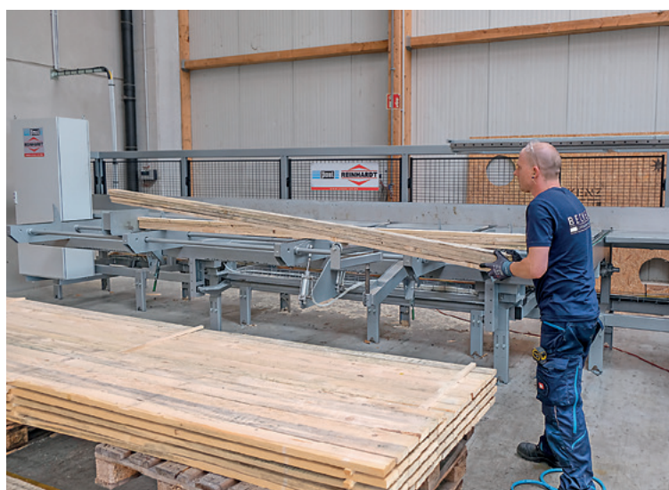
Erleichterte Materialaufgabe: Eine höhenverstellbare Stützrolle erleichtert das Auflegen der Werkstücke
