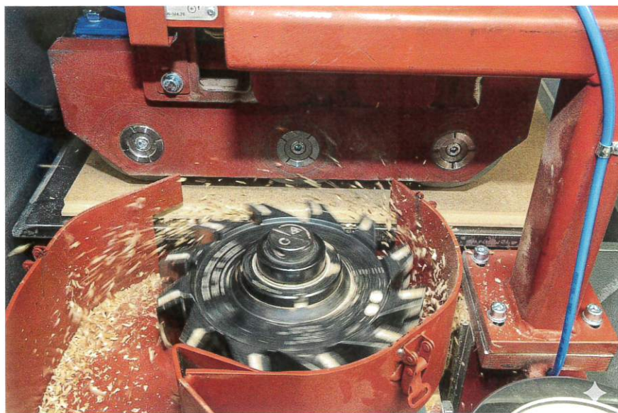
Links: Die Seitenprofilier- einheit ermöglicht eine Rundum-Bearbeitung von Plattenmaterial. Unten: Die entstandenen Nuten und Profile überzeugen durch eine hohe Präzision – und zwar auf unter- schiedlichsten Materialien
